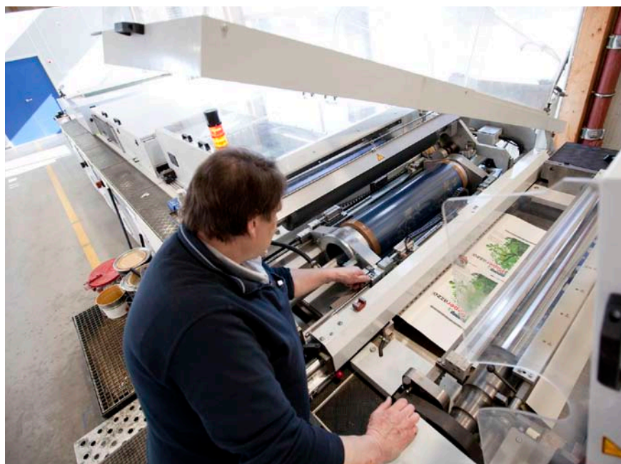
Dann erfolgte die Lackierung in einer Flexo- und Siebdruckmaschine von Steinemann: erster Durchgang Strukturlackierung ...
