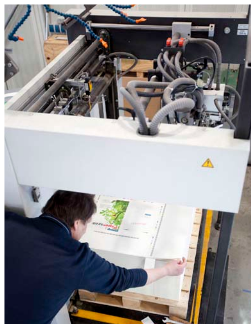
... und im zweiten Durchgang abschließend die Relief-Lackierung. Beides im Siebdruckverfahren
